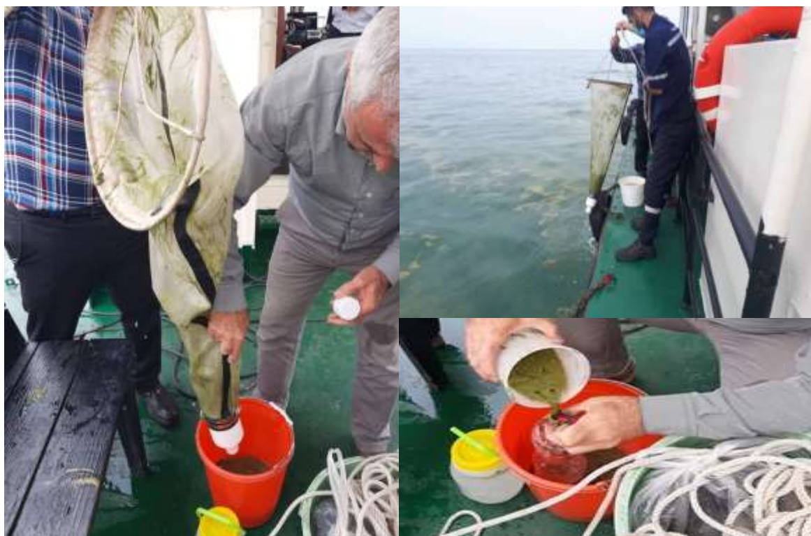
شکل ۲: نمونه برداری از فیتو- زوپلانکتون، شانه دار و پارامترهای فیزیکوشیمیایی در دریای کاسپین،
