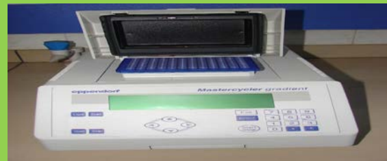
PCR Ependorf: برای تکثیر DNA واکنشهای زنجیره ای پلیمرز
