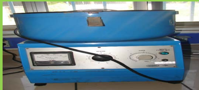
KOKUSAN Osk H-782 برای جدا سازی فازهای نمونه های مورد آزمایش
