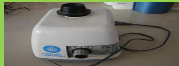
شیکر LABTRON LS-100: برای همزدن محلول استفاده می شود.
