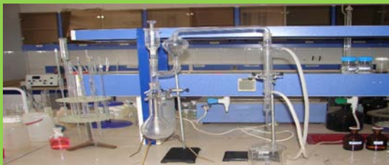
سیستم کج‌دال : برای اندازه گیری ازت کل در نمونه ها به کار
