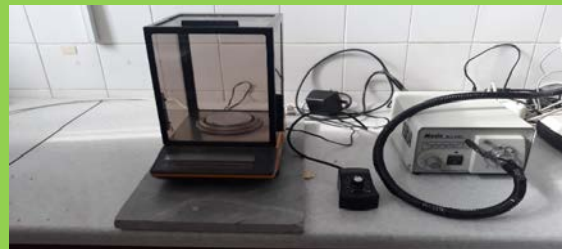
ترازوی ۰/۰۰۰۱ : جهت وزن کردن نمونه ها
