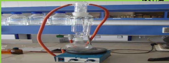
اجاق سوکسله: برای اندازه گیری میزان چربی در نمونه ها استفاده می شود.
