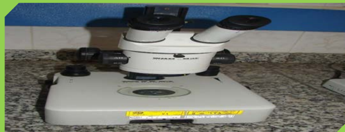
لوپ دو چشمی مدل WILD M3C G جهت مشاهده و شمارش آرتمیا و سیست به کار می رود.
