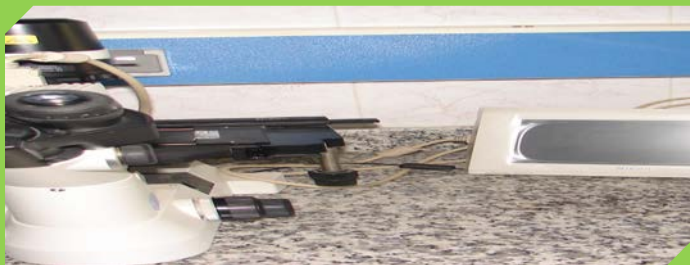
میکروسکوپ اینورت مدل NIKON TS100 جهت شمارش و شناسایی جلبکها و مونیتور آن برای مشاهده و عکسبرداری از جلبک استفاده می شود.
