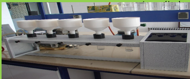
پایه عصاره گیر خاک: برای عصاره گیری از نمونه های خاک به کار می رود.
