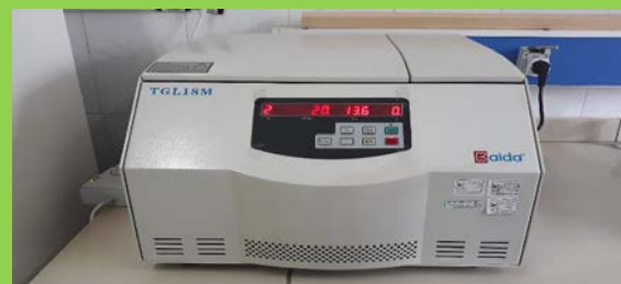
سانتریفیوژ یخچال دار: جهت جداسازی فازهای مواد مورد آزمایش در دمای دلخواه
