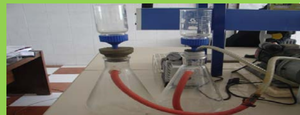
وکیوم: برای فیلتر کردن نمونه ها به کار می رود.
