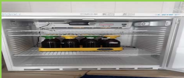
BOD سنج ۱۲ خانه : برای اندازه گیری اکسیژن مورد نیاز بیوشیمیایی به کار می رود.
