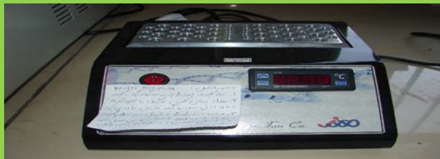
: Heater block جهت گرمادهی نمونه های موجود در تیوب های کوچک
