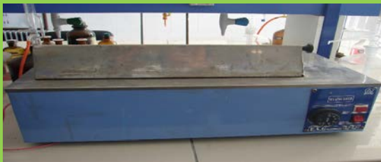
اجاق سوکسله: برای اندازه گیری میزان چربی در نمونه ها استفاده می شود.
